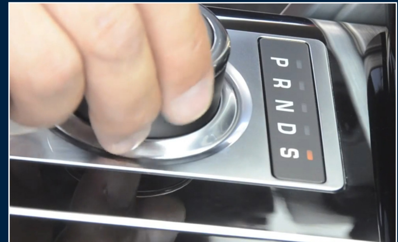
LG-670-00 Klappen-Sportauspuff-Steuerung: Mode S • laut / Mode D • leise Valve controlled sports exhaust control: Mode S • loud / Mode D • quiet
