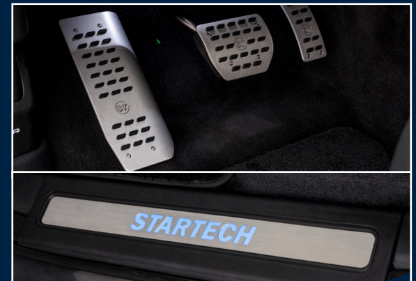
LG-819-00 / LG-819-01 / LC-350-00 Aluminium Pedalauflagen, Fußstütze und Einstiegsleisten vorne Edelstahl beleuchtet Aluminium pedal pads, footrest and entrance panels front, stainless steel, illuminated
