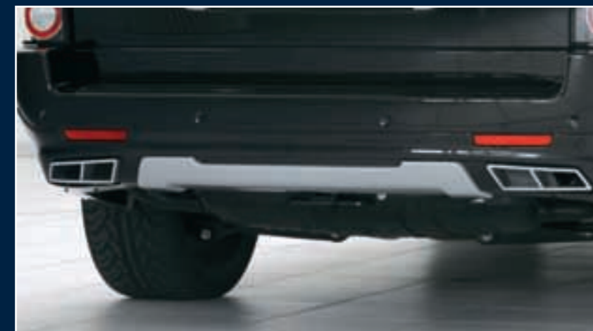
RA-400-00 ab MJ 2002 / from MY 2002 Heckschürzen-Aufsatzelement, PUR R-RIM, mit integrierten Auspuffblenden inkl. Rohrführung Rear skirt attachment element, primed for painting, with integrated exhaust tips and connection piping
