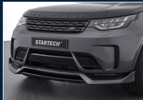
LR5-200-00 / CHR-000-38 Frontstoßfänger, PUR R-RIM und STARTECH Schriftzug für Motorhaube Front bumper PUR R-RIM and STARTECH logo for bonnet
