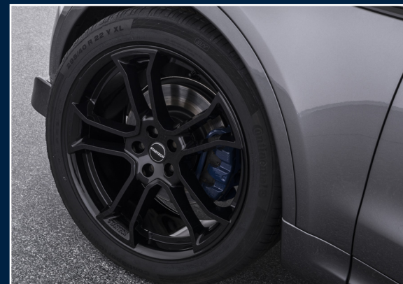
1R5-002-40 MONOSTAR R Leichtmetallräder, schwarz glänzend, 10J x 22 (VA + HA) MONOSTAR R light alloy wheels, black glossy, 10J x 22" (FA + RA)
